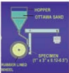
Esquema de la instalación de ensayo para el test G-65
